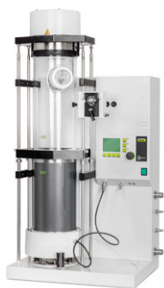
Nano Spray Dryer B-90 HP Spray Dryer untuk sam- pel dan partikel kecil
